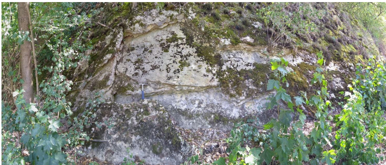
Foto 35 Detail obnaženého skalního masivu č. 7. Zřetelně lze vidět, že vrstvy vápence jsou ukloněny konformně se svahem, což zvyšuje riziko dopadu uvolněných horninových bloků do prostoru vozovky.
