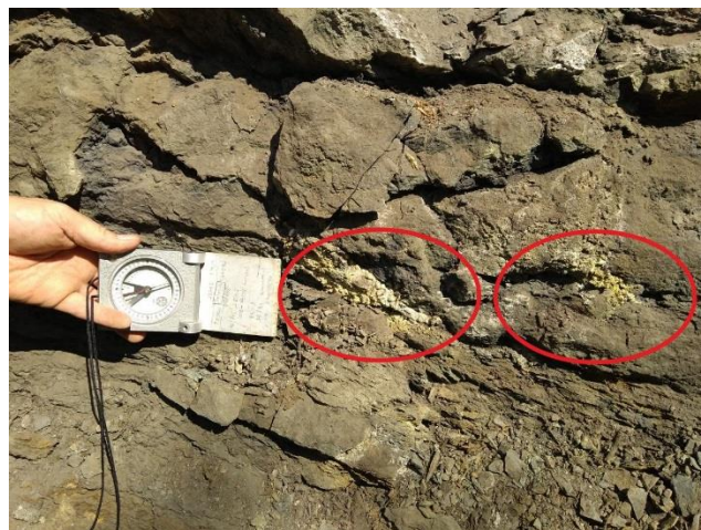
Foto 9 Poloha černých pyritických břidlic ve svahu č. 2, místy s výkvěty sekundárních minerálů.
