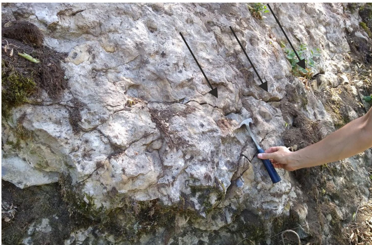
Foto 38 Detail zátrhů ve svahu č.7 napovídajících, že v budoucnu opět dojde k dalšímu sesunutí vrstvy vápence.
