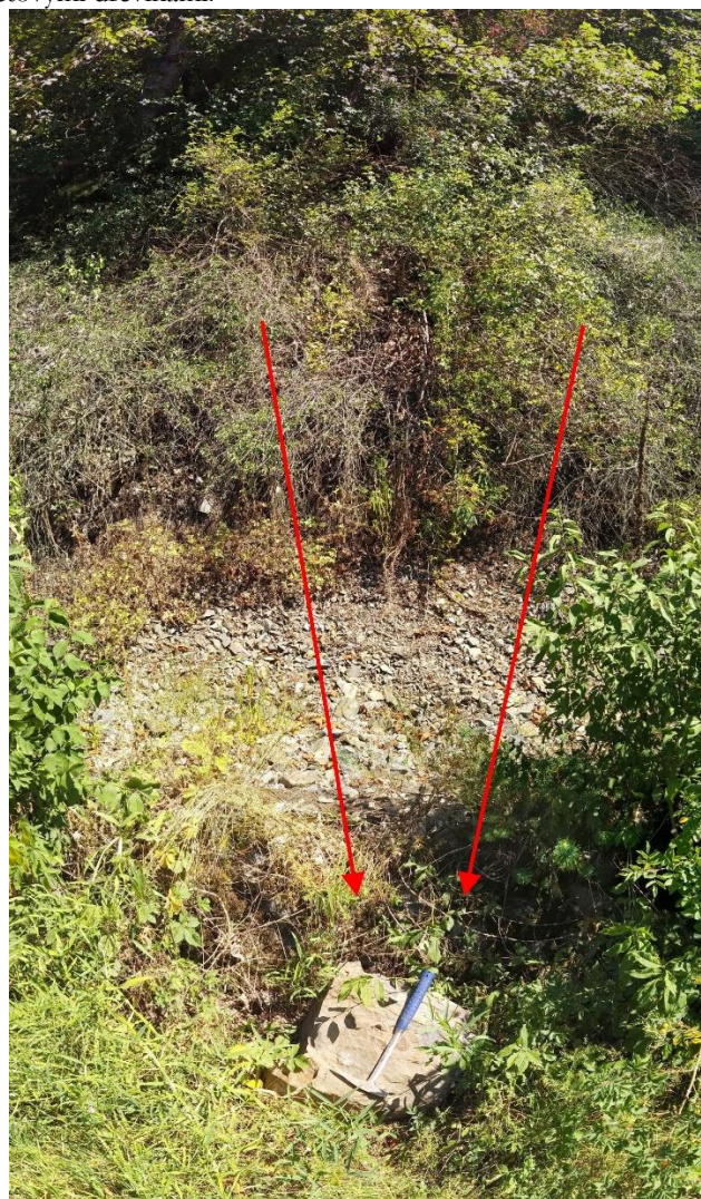
Foto 21 Dopadnuvší blok horniny o maximálních rozměrech 60 \times 50 \times 30 cm pocházející z neznámé zdrojové oblasti skalního objektu č. 4.
